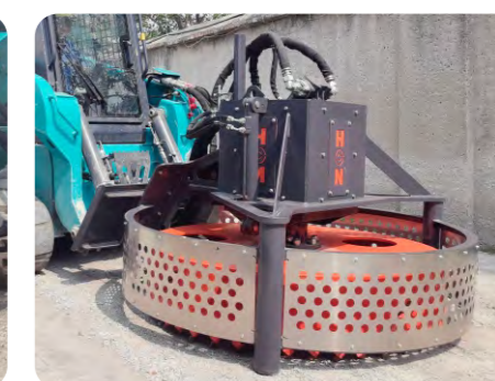
Manhole milling machine
